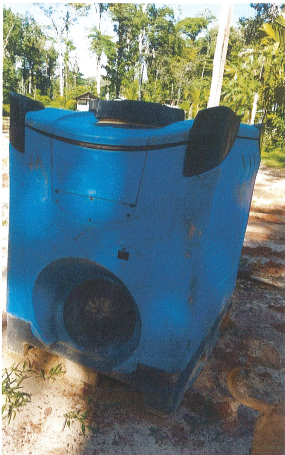
Bac de rétention des huiles usagées
